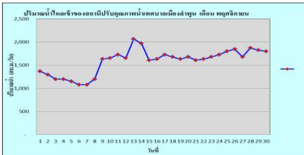
กราฟแสดงปริมาณน้ำไหลเข้าระบบบำบัดน้ำเสีย
